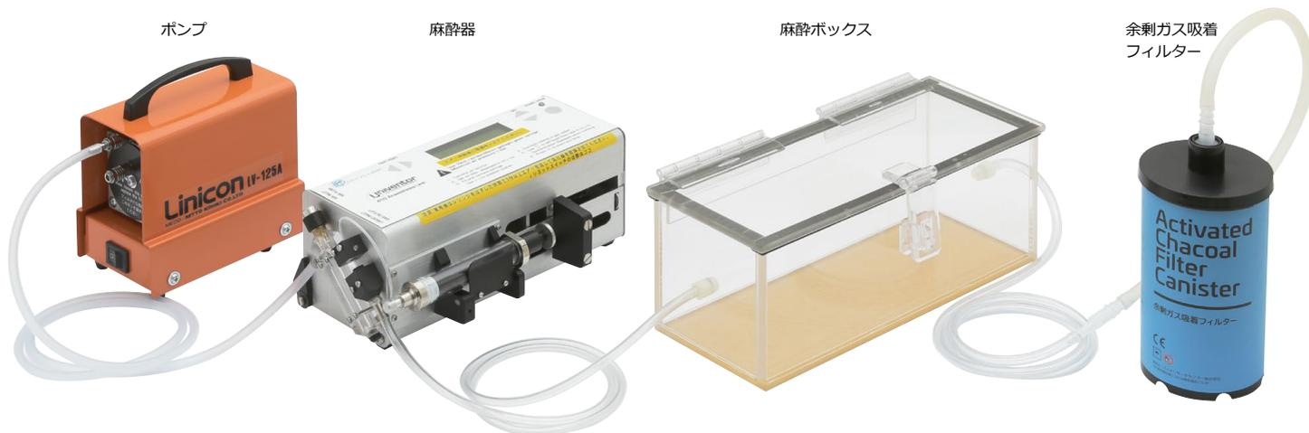
余剰ガス回収装置接続例
