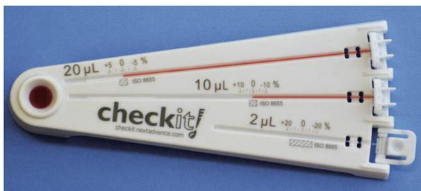
Pipette Checkit™ ピペット検査器
