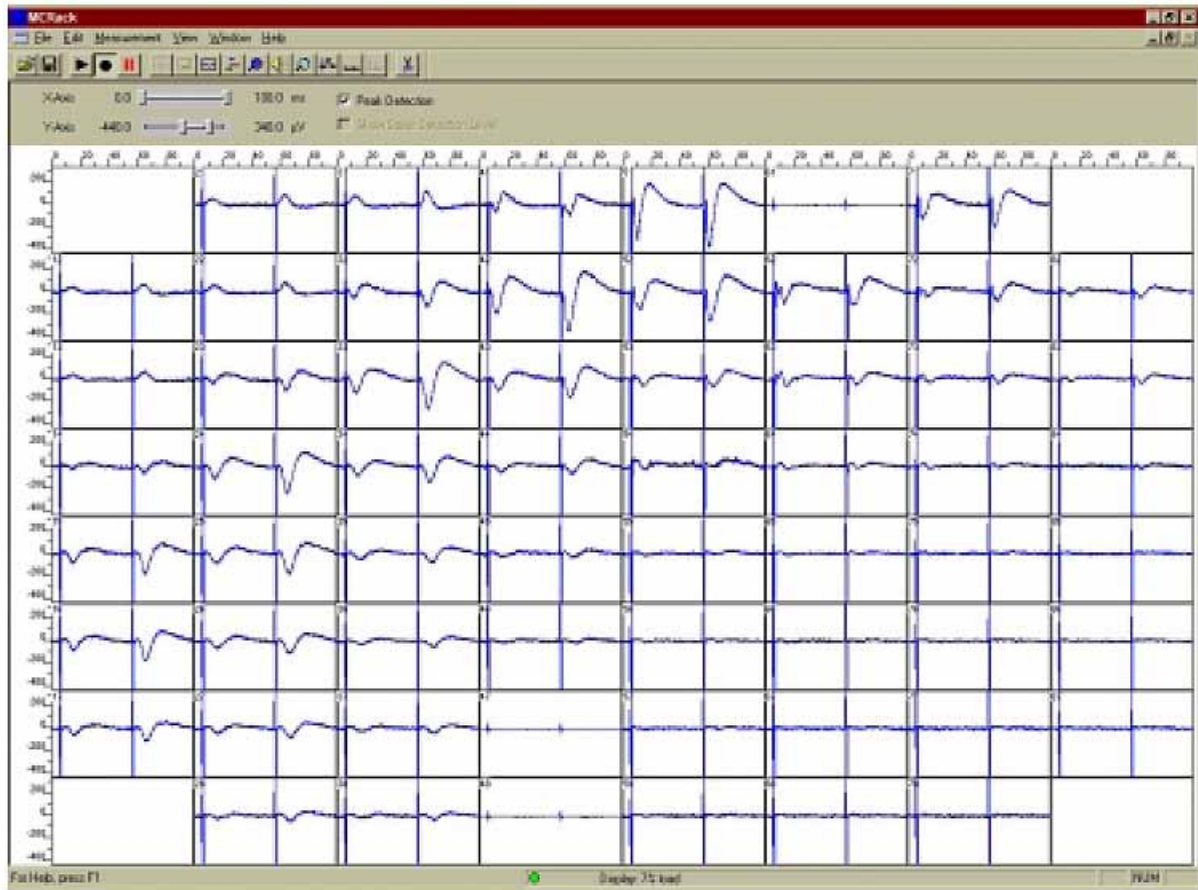
図-7: 図はMEAアレー全体へのPPFを示します。刺激した電極は61番でPPFはパルス幅 140\ \mu\text{s} 、 \pm 100\ \mu\text{A} のダブルパルス(図-6 参照)で誘発されます。電極 47 番と 48 番はノイズの干渉を回避するためにグラウンドに対しシャントされます。
