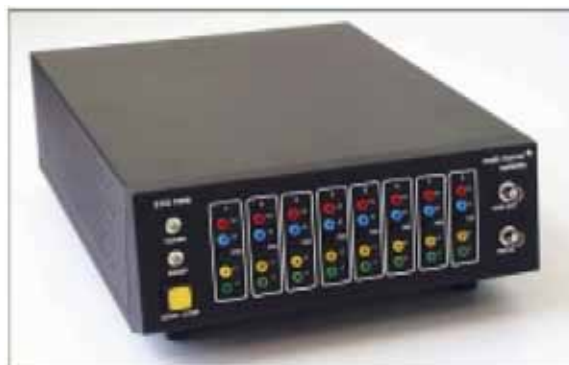
図 3 : 外部の SIU を必要とせず、電圧と電流出力ができる MCS-STG1008 8ch スティムレーター
